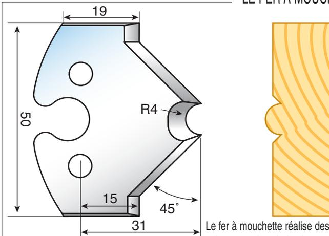
Le fer à mouchette réalise des cannelures sur des pieds, des moulures de lambris. Ses deux arêtes peuvent aussi servir à chanfreiner.
