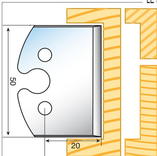
Classique, le fer à feuillure est le modèle de base équipant tous les porte-outils d'origine. Il peut être remplacé comme sur notre porte-outil multifonctions par des plaquettes carbures montées sur un porte-fers.
