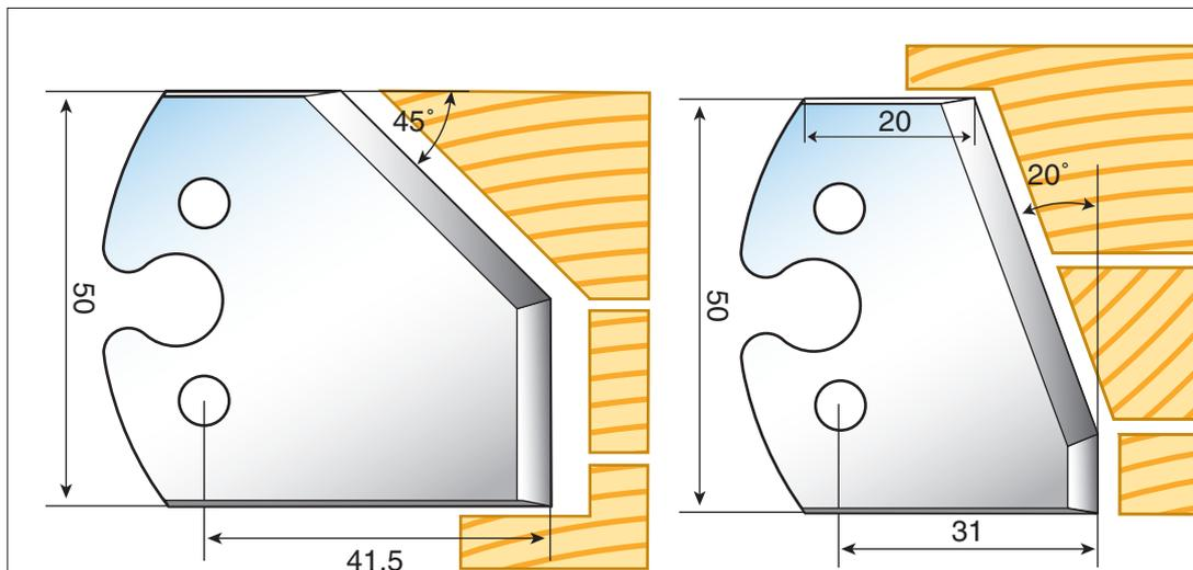
Le chanfrein est largement utilisé pour un grand nombre de travaux et reste un des fers de base pour casser un angle, réduire l'aspect trop massif d'un plateau ou d'un montant. On pourrait penser utiliser le fer à 45° réf. F205 pour réaliser des assemblages d'onglet. Attention, suivant l'angle d'attaque de votre porte outil, vous aurez un angle réel sur le bois différent de 45°.
