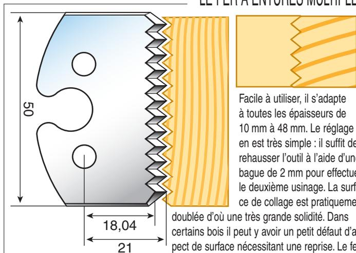
Facile à utiliser, il s'adapte à toutes les épaisseurs de 10 mm à 48 mm. Le réglage en est très simple : il suffit de rehausser l'outil à l'aide d'une bague de 2 mm pour effectuer le deuxième usinage. La surface de collage est pratiquement doublée d'où une très grande solidité. Dans certains bois il peut y avoir un petit défaut d'aspect de surface nécessitant une reprise. Le fer laissant en effet une toute petite frange de bois fragile en surface.
