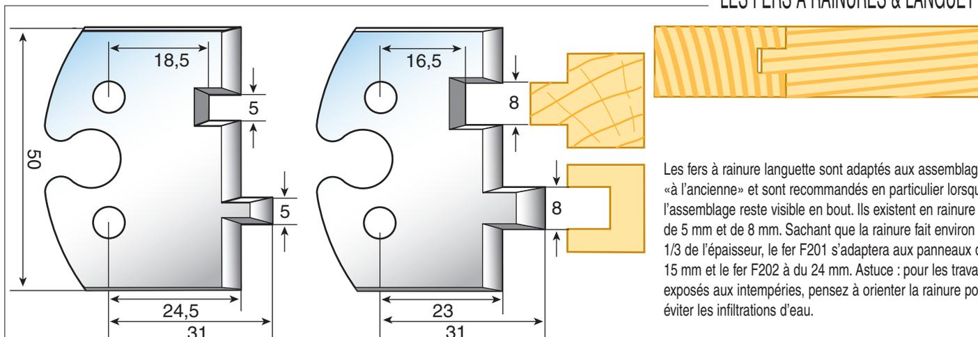
Les fers à rainure languette sont adaptés aux assemblages « à l'ancienne » et sont recommandés en particulier lorsque l'assemblage reste visible en bout. Ils existent en rainure de 5 mm et de 8 mm. Sachant que la rainure fait environ le 1/3 de l'épaisseur, le fer F201 s'adaptera aux panneaux de 15 mm et le fer F202 à du 24 mm. Astuce : pour les travaux exposés aux intempéries, pensez à orienter la rainure pour éviter les infiltrations d'eau.
