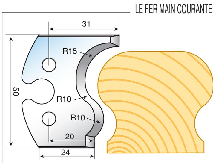
Le fer F229 vous permet de réaliser une main courante d'escalier. L'usinage se fera simplement en 2 passes sur une pièce de bois d'environ 50 x 50 mm.
