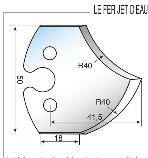
Le jet d'eau est la pièce située en bas de chaque battant. Elle est destinée à rejeter les ruissellements et projections à l'extérieur. Le fer F209 réalise l'usinage extérieur ainsi que la rainure inférieure dite «goutte d'eau» évitant les remontées d'eau vers la pièce d'appui.
